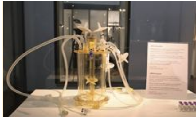
Kunststoffzylinder, Rührwerk, Schläuche: Dieser Bioreaktor war bei der Produktion der ersten Impfstoff-Charge von BioNTech im Einsatz.
