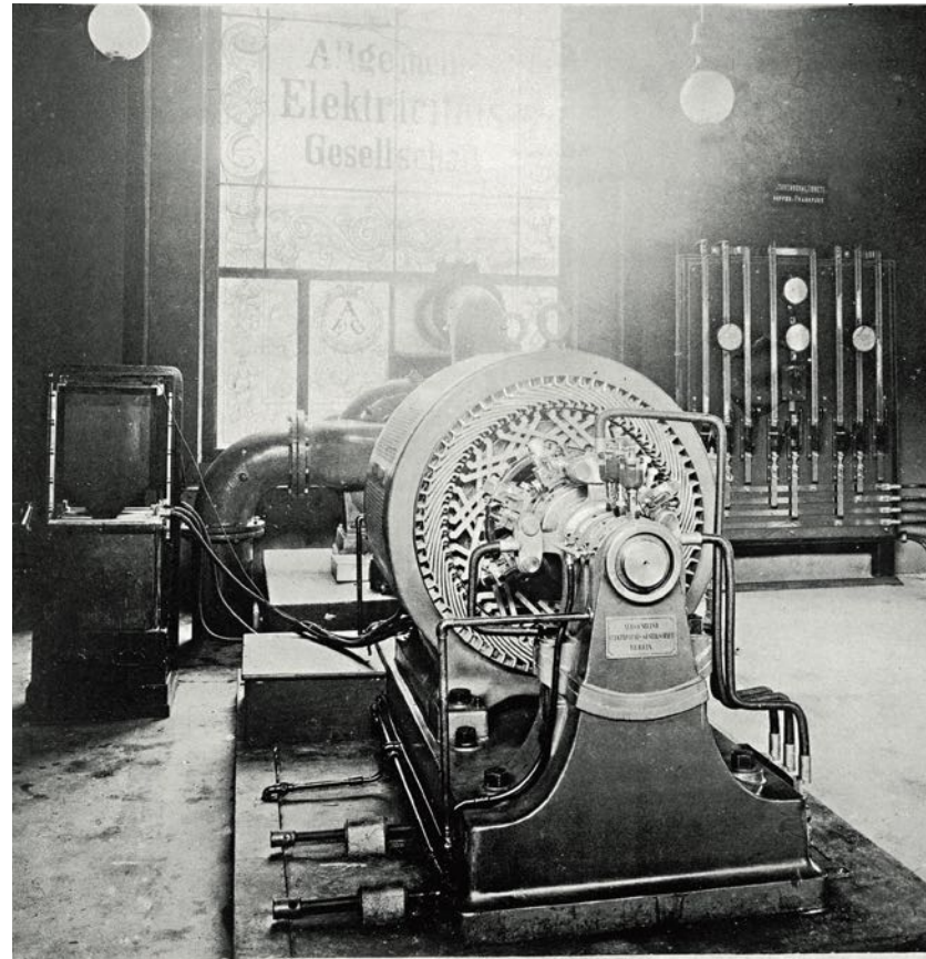
100-PS Drehstrommotor auf der »Internationalen Elektrotechnischen Ausstellung« 1891 in Frankfurt.
