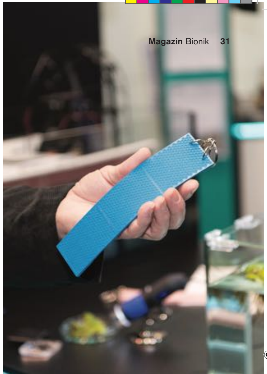
Wie ein Schwimmfarn funktioniert die bionische Beschichtung, die den Reibungsverlust von Schiffen im Wasser vermindert.
