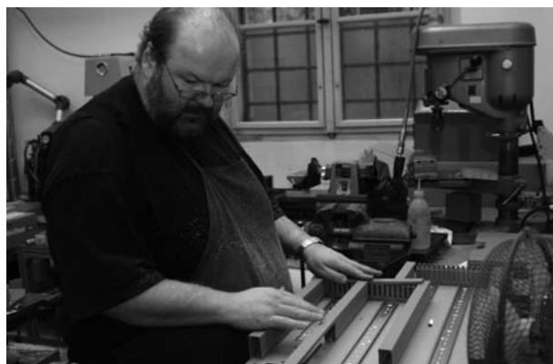
Stromversorgung – Montage der Trägerplatte
