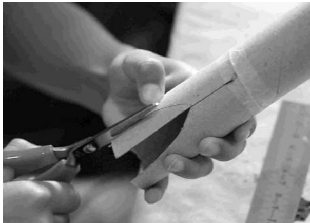
Herstellen von Orgelpfeifen aus Papprohren.
